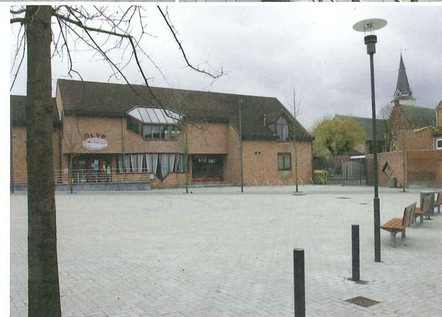
Ook lichtarmaturen staan aan de rand van het plein: indirect licht bij zitbanken, direct licht langs voetgangersverbinding
